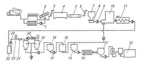
Машино-аппаратурная схема комплекса технологического оборудования для производства осветленного яблочного сока
