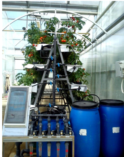
Рис. 2 - Растворный узел установки пятиярусной узко-стеллажной гидропоники (производство НПО «ФИТО»).
