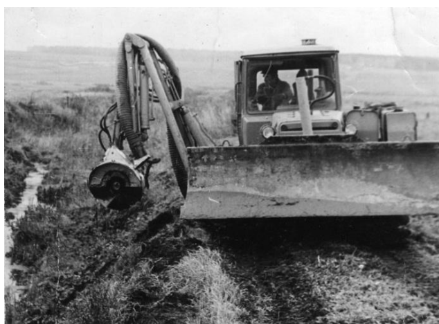
Рис. 2. - МРО, настроенное на работу в качестве фрез-метателя, и очистка им «сухого» канала
