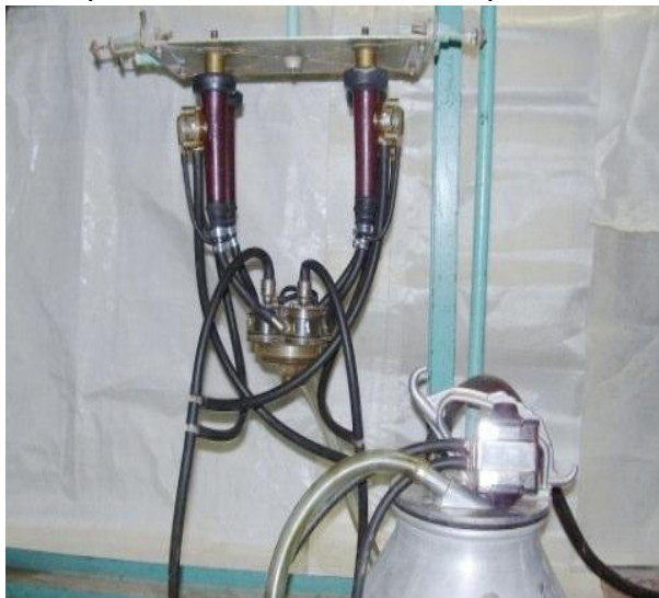
Рис. 2 – Общий вид доильного аппарата с однокамерными доильными стаканами
