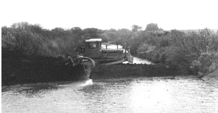
Рис. 1. - МРО, настроенное на работу в качестве насоса, и работа им в порыве
