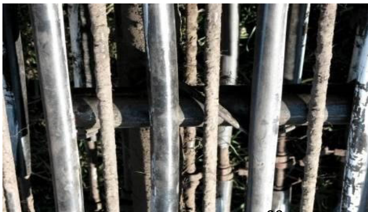
Рис. – Вид элеватора с активными прутками на картофелекопатель КТН-2В
