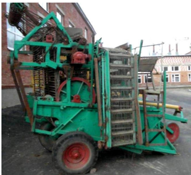
Рис. 2 - Модуль для переоборудования копателя КСТ-1,4 в картофелеуборочный (морковеуборочный) комбайн с загрузкой в рядом движущееся транспортное средство
