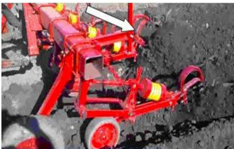
Рис. 2 - Момент срабатывания предохранителя секции культиватора показан стрелкой
