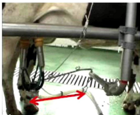
Правильное положение подвесной части доильного аппарата
